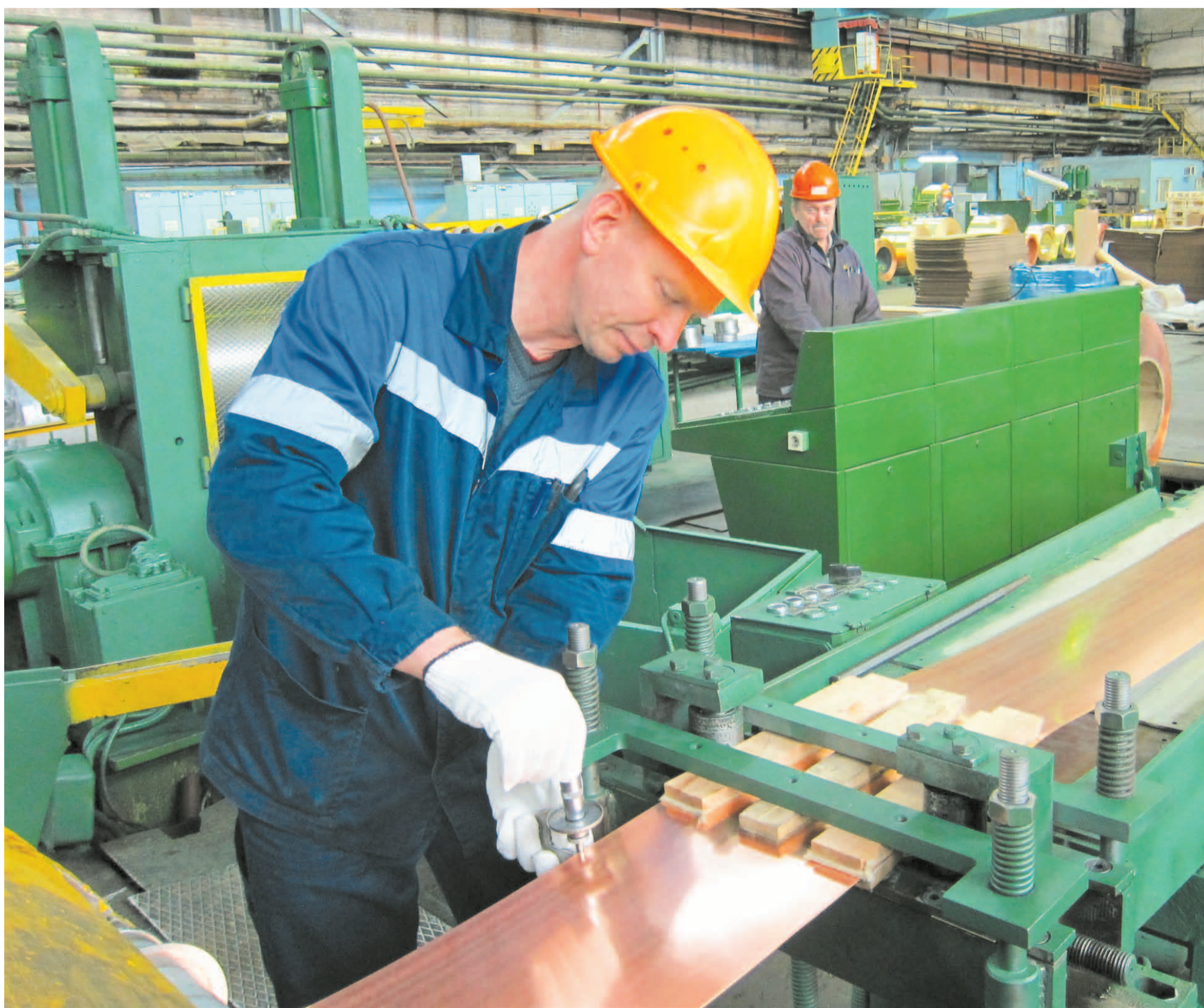
Операторы линии по ОЦМ Александр Тимонин (на переднем плане) и Сергей Маракулин проводят операцию по обкатке (скруглению) кромок медной трансформаторной ленты на линии резки «Шкода»
