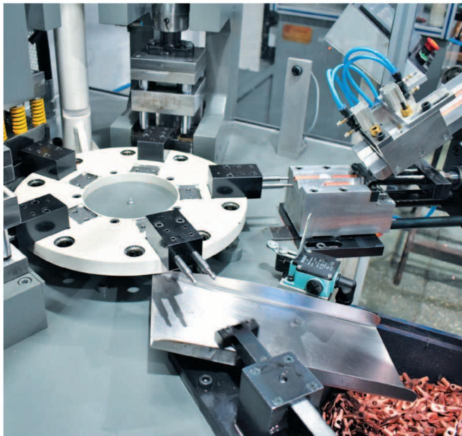
Автоматический станок для изготовления кабельных наконечников.
