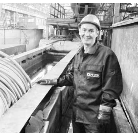
Травильщик А. А. Солодяников во время процесса травления прессованной заготовки в бухтах
