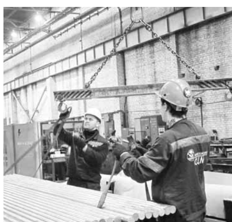
Процесс приемки прутков. Укладчики-упаковщики Р. С. Волков и М. О. Лопаткин перед упаковкой на линии «Робопак» в бумажную тару протирают прутки специальным растворителем «Нефрас» для удаления загрязнений, оценивают качество поверхности и размеры готовой продукции
